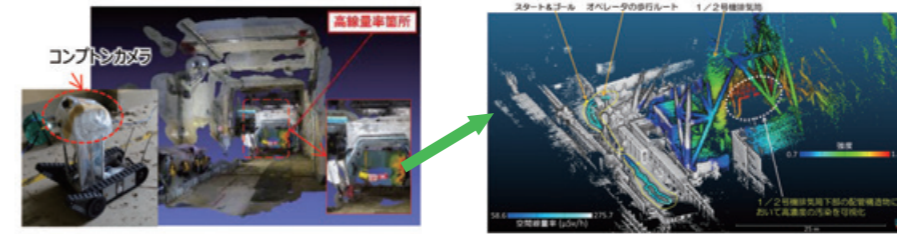
1F1号機の建屋内の高濃度汚染箇所の可視化結果(2018年)
